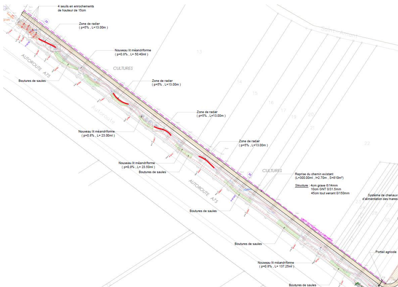
Figure 10. Implantation en plan du tracé actuel et projet du ruisseau de Saint Sandoux renaturé
